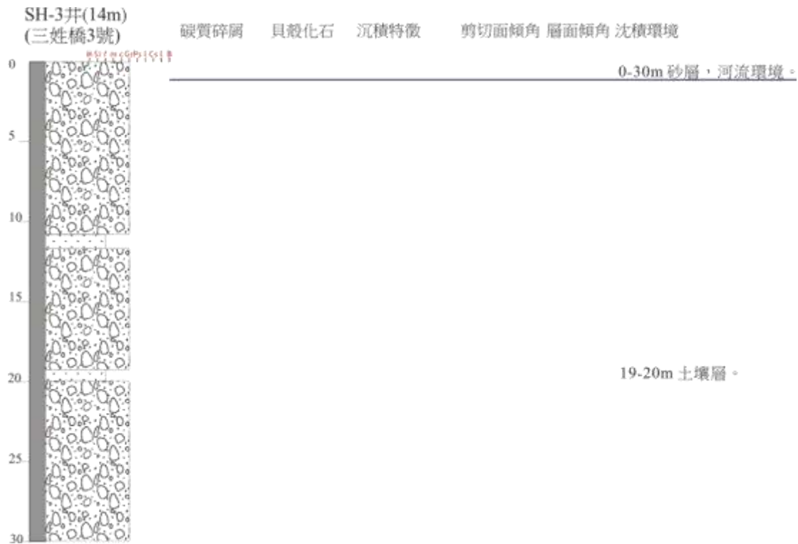
附圖 1-20 三姓橋 3 號鑽孔柱狀圖
